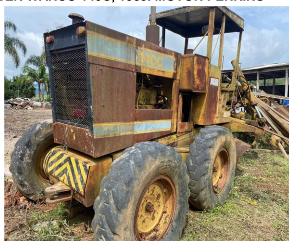
LOTE 12 – MOTO NIVELADORA (PATROL), HUBER WARCO 140C, 1985. MOTOR PERKINS
